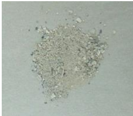
Figura 68: Esempio di conchiglie dopo la fase di frantumazione con il cilindro in teflon descritto in 3.1.2 Metodi di trattamento delle conchiglie .
