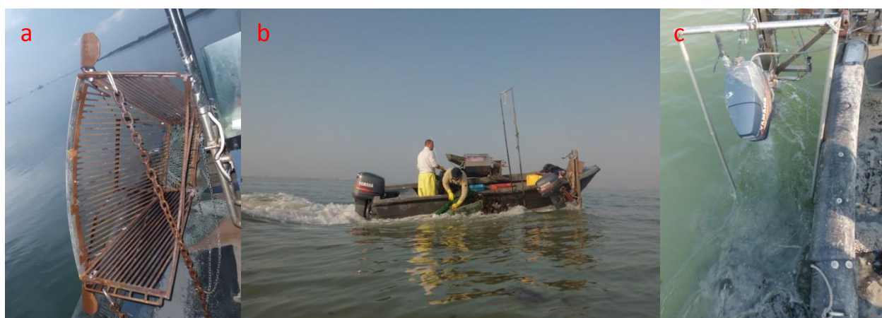
Figura 49: Prelievi effettuati nei punti di campionamento B, V e A mediante "rusca" chioggiotta montata su barchini: la rusca (a), tipologia di imbarcazione utilizzata per questo tipo di pesca (b), il prelievo nel punto B (c) – foto G. Cipolato.
