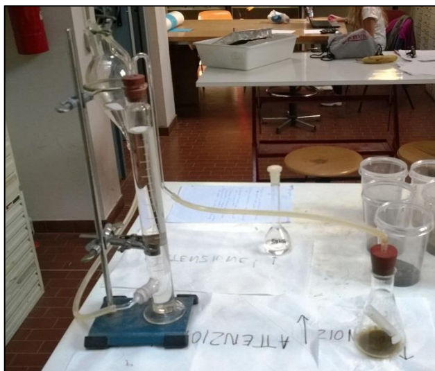
Figura 3.5 – Determinazione gas-volumetrica del calcare con calcimetro.
