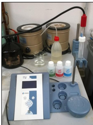
Figura 3.3 - pH-metro utilizzato per la determinazione del grado di reazione e reagenti impiegati per la taratura.
