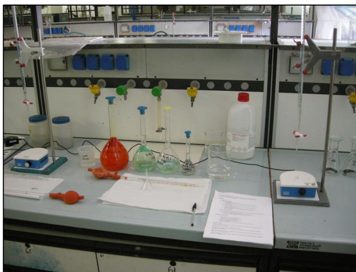
Figura 3.4 - Reagenti e strumentazione utilizzati per la determinazione del carbonio organico.
