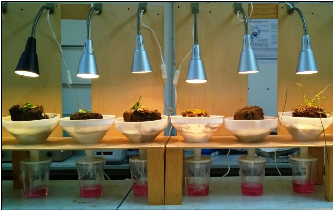
Figura 3.12 - Apparato sperimentale per la raccolta della fauna del suolo.
