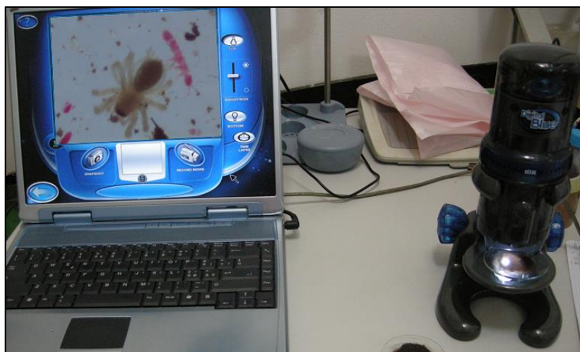
Figura 3.13 - Riconoscimento della mesofauna mediante microscopio digitale.
